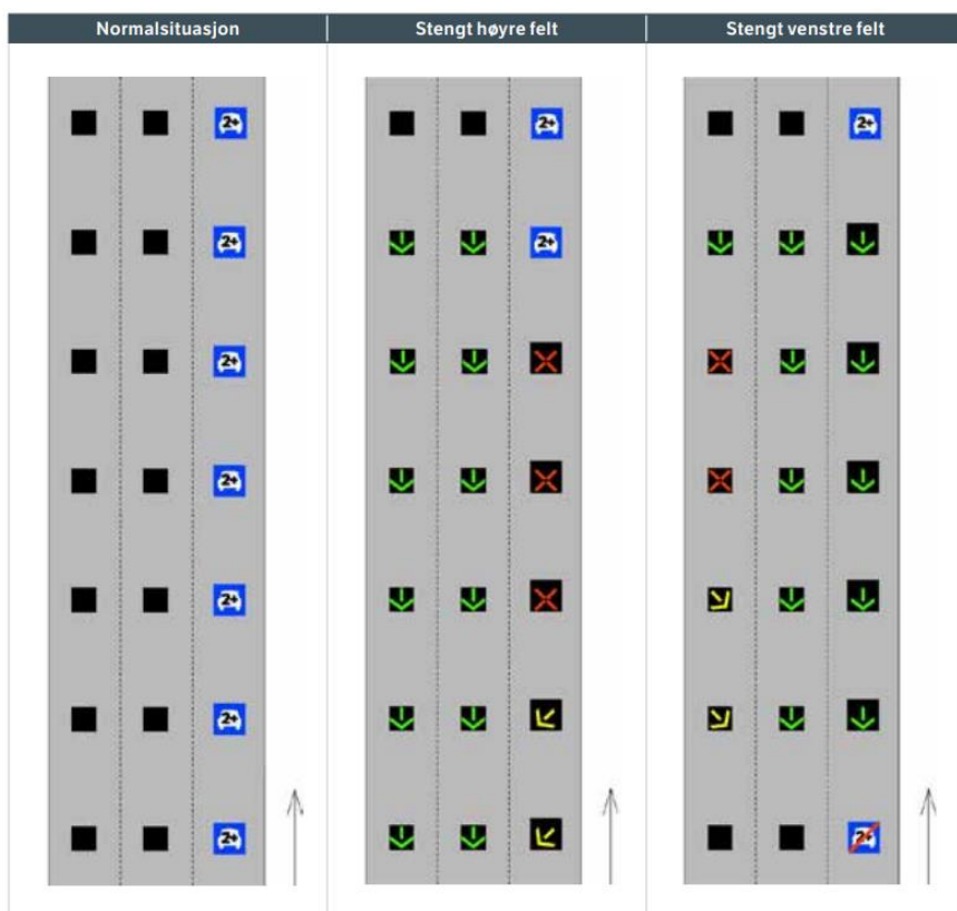
Figur 6-9: Trafikkstyringssystem med skilt for feltreservasjon og kjørefeltsignal i samme variable skilt (Figur fra Håndbok R311, s. 19).
