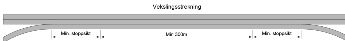
Figur 6-4: Minimumslengder ved vekslingsstreking. Tegnet i Autocad.
