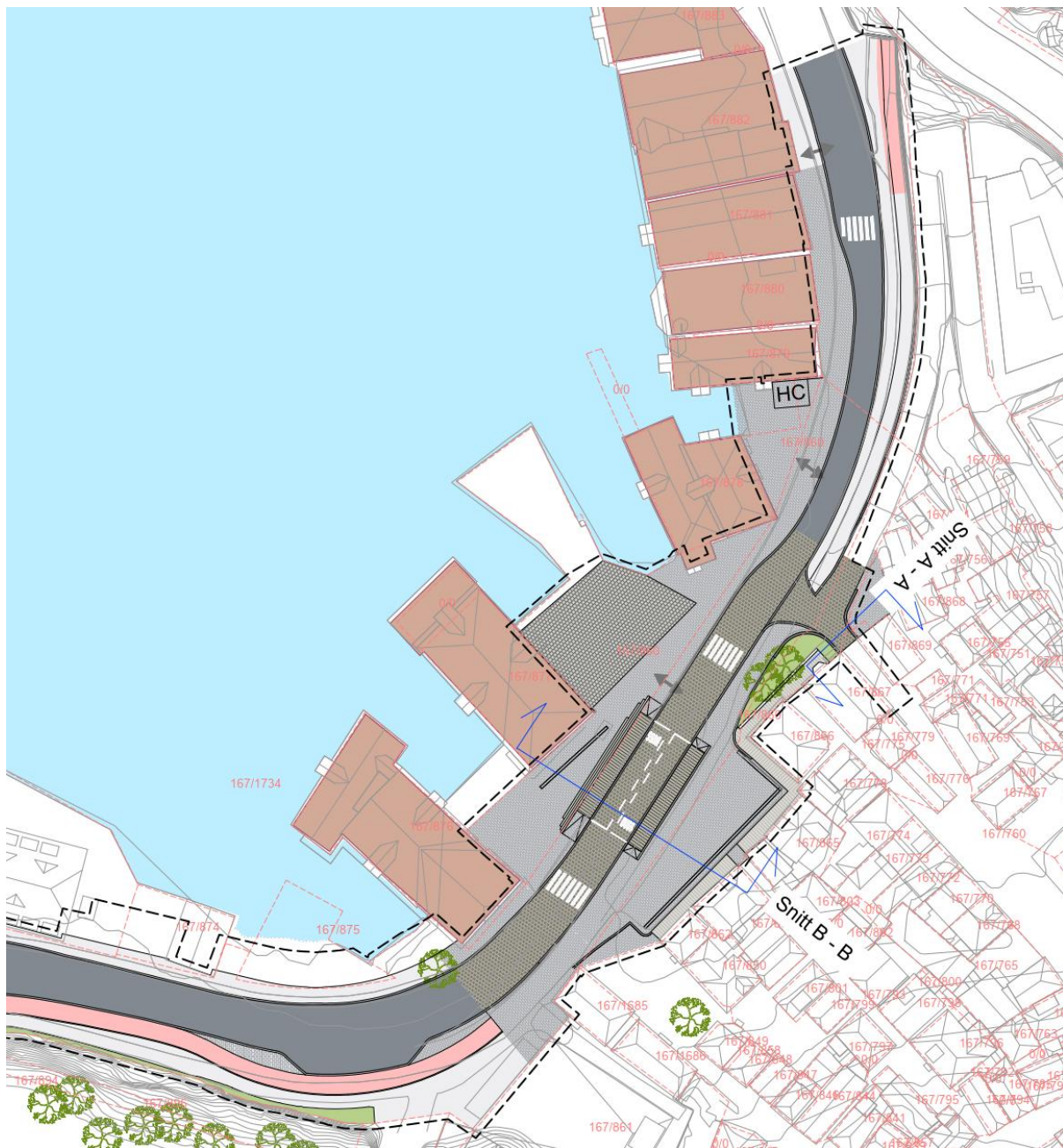
Figur 3-11: Illustrasjonsplan for Skutevikstorget. Fredet bebyggelse markert med lys brun farge. Ventesone for bussholdeplassene ligger hevet over plassen med trinn i bakkant og korte ramper i lengderetningen. Se tegning BT5-T-S2-O-0001 for tekst og tegnforklaring.
