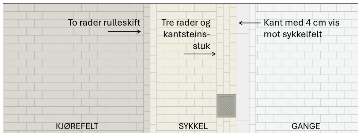
Figur 3-6: Prinsipp for dekke og kanter ved Bryggen, fra venstre mot høyre: kjørefelt, sykkel og gangareal (fortau/torg)
