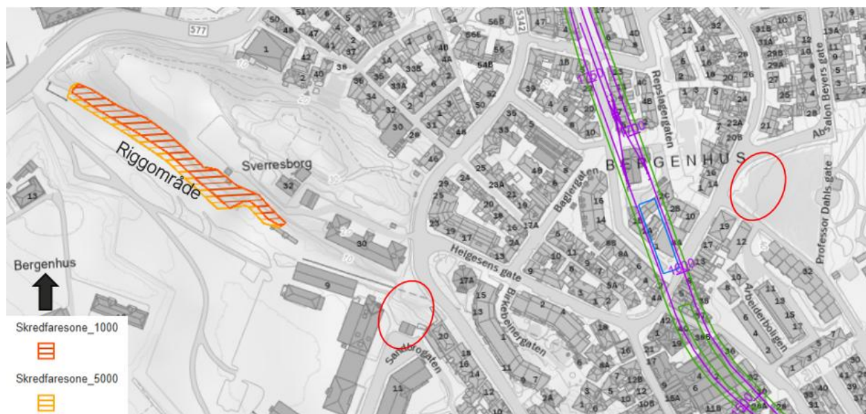
Figur 4-4: Faresone for steinsprang ved riggområde Koengen. Fra NVE Atlas. Områder for tiltak i dagen for adkomst til Sverresborg holdeplass vist med røde sirkler. Bybanetrasé i tunnel (profilering er ikke oppdatert).
