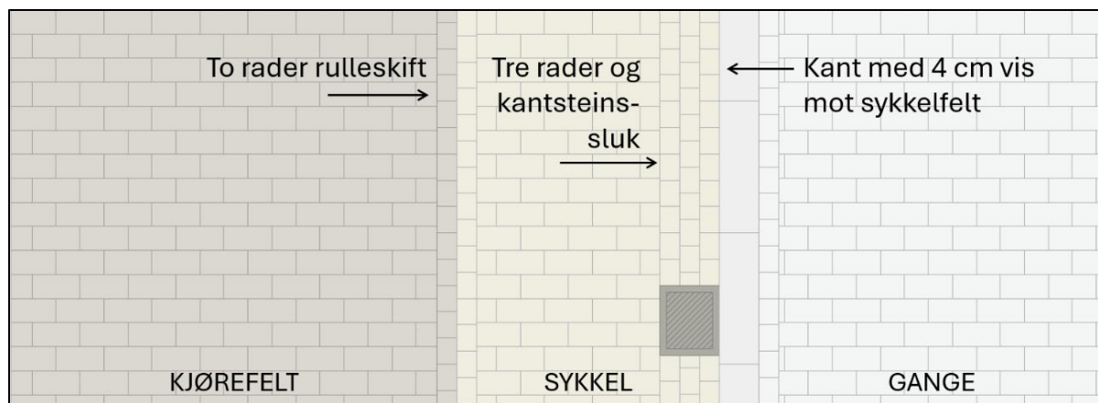
Figur 6-12: Prinsipp kantavgrensning sykkelfelt. Avgrensningen mellom kjørebane og sykkelfelt settes med storgatestein i vekselvis lys og mørk utførelse og uten høydeforskjell mellom formålene. Mot fotgjengerareal settes platekantstein med 4 og 6 cm vishøyde mot sykkelfeltet.
