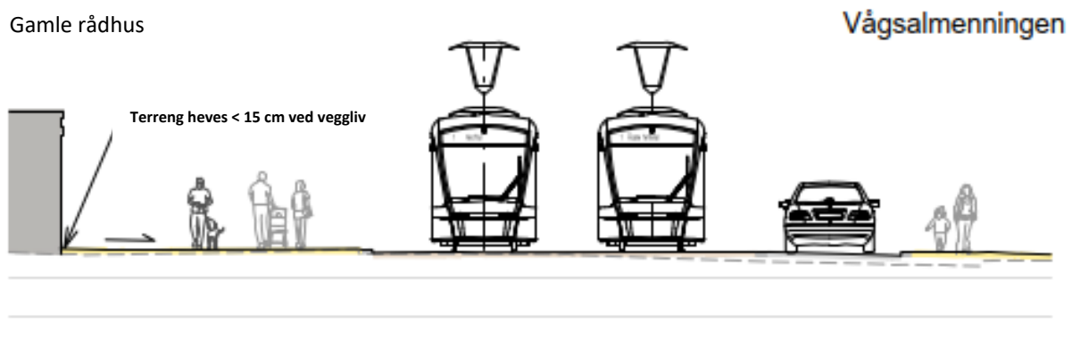
Figur 7-6: Snitt som viser justering av terreng inntil Gamle Rådhus.
