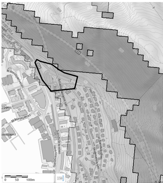
Figur 27: Aktsomhetskart for steinsprang (NVE). Mørk skravur markerer løснеområde, lys skravur markerer utløpsområde. Svart omkrets markerer kartleggingsområdet.
