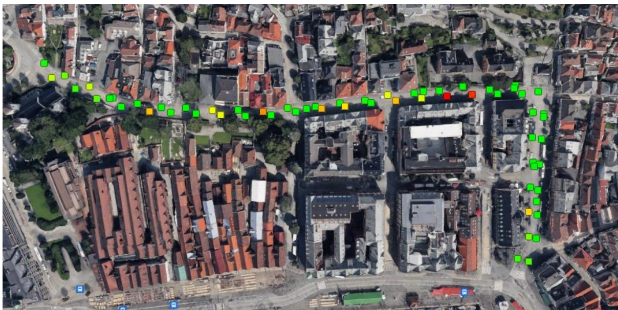
Figur 5-1 Bæreevne for strekningen med brostein i fargeskala. Røde prikker har bæreevne 8 tonn, grønne har bæreevne 14 tonn.
