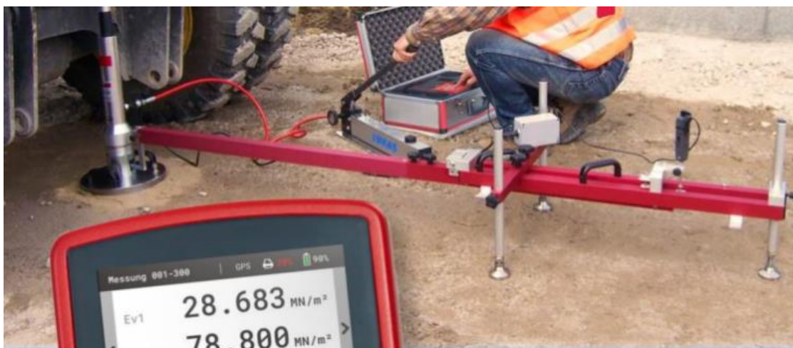
Figur 2-19 Platebelastningsutstyr med last og deformasjonskontroll. Mothold mot aksling i tungt kjøretøy. 300 mm platestørrelse.
