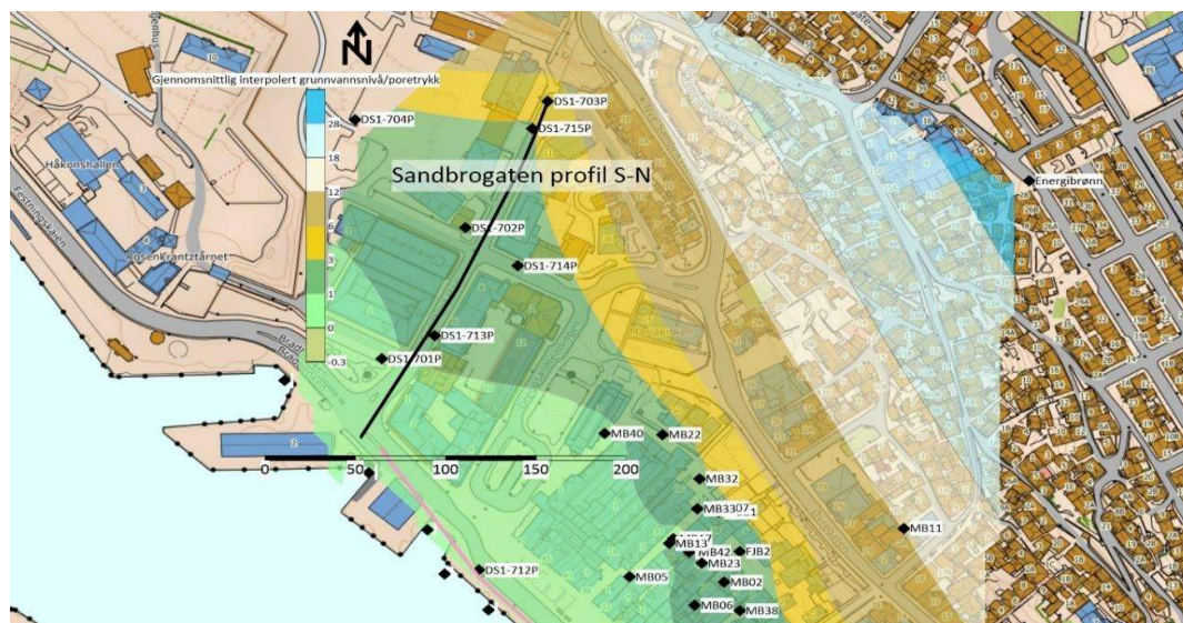
Figur 2-2: Gjenomsnittlig målt poretrykk ved Sandbrogaten. Poretrykksmålere er vist med sorte ruter. Måleperioden for målerne varierer, november 2019 til mai 2021 for målerne DS1-701P, DS1-702P, DS1-703P, DS1-704P og mai 2020 til mai 2021 for DS1-713P, DS1-714P, 715P. Miljøbrønnene (MBx) er data fra overvåking av vannstand ved Bryggen fra mai 2020 til mai 2021.
