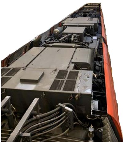
Figur 3: Komponentdistribusjon på taket av Variobahn
