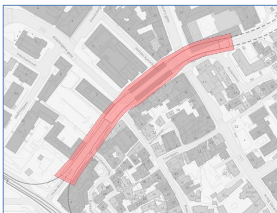
Figur 4-8: Grovt stipulert omfang av byggegrop i Peter Motzfeldts gate og Nygaten/Heggebakken. (Dersom alternativet blir med videre må det treffes tiltak for at Manufakturhuset ikke skal berøres.)
