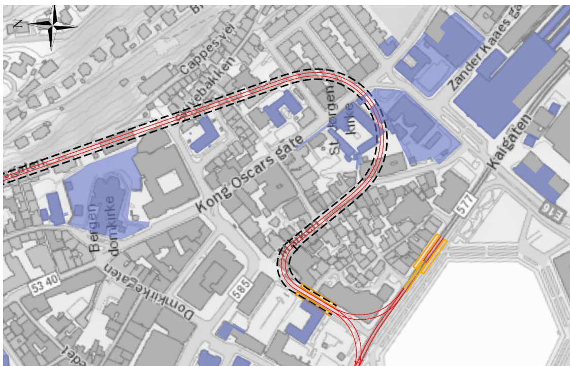
Figur 2-4. Alternativet beskrevet i Hvitboken. Etter at banen går under bakken, gjør den en krappe kurve mot sør før den igjen vender nordover.
