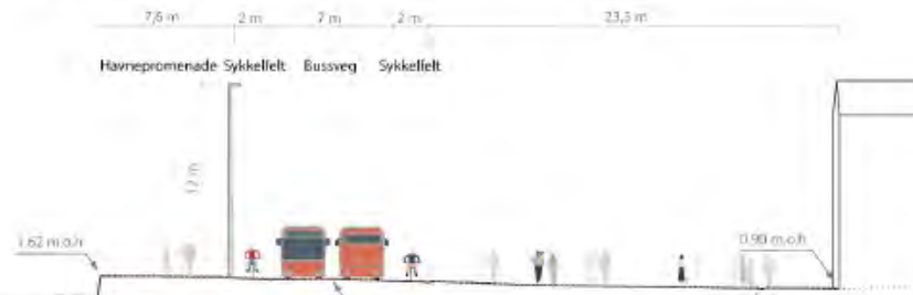
Figur 4-7: Snitt over dag- og tunnelalternativet ved Bryggen. Stiplet linje viser dagens gatenivå.
