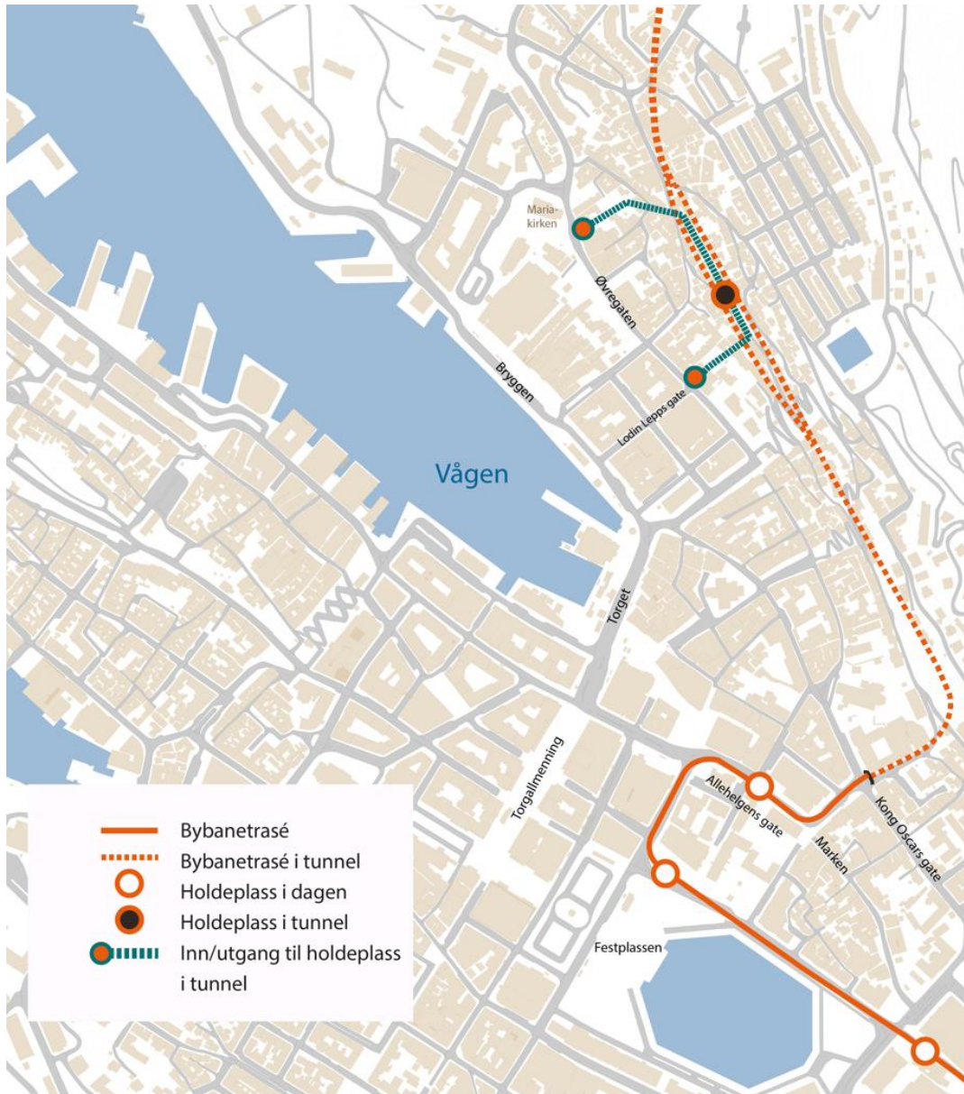
Figur 11 – Tunnelalternativ 2C1, vurdert som det beste tunnelalternativet.
