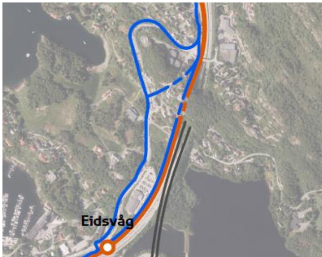
Figur 4-91: Vurderte løsninger mellom Eidsvåg og Tertneskrysset. Vurderte løsninger for sykkel vist i blått, anbefalt løsning for bane vist i oransje.
