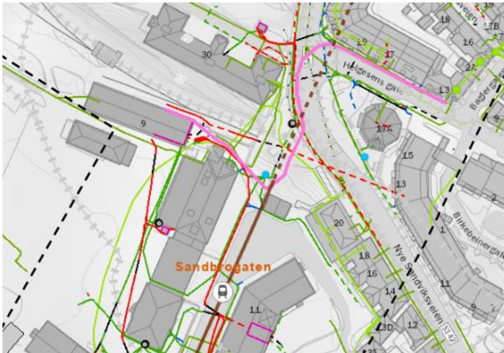
Figur 3-12: Kabler i grunnen i indre del av Sandbrogaten. Rosa linje viser viktige høyspentkabler. Brun rett strek indikerer Bybanen. Grønne og røde streker viser mindre kabler i området som det er enklere å flytte.
