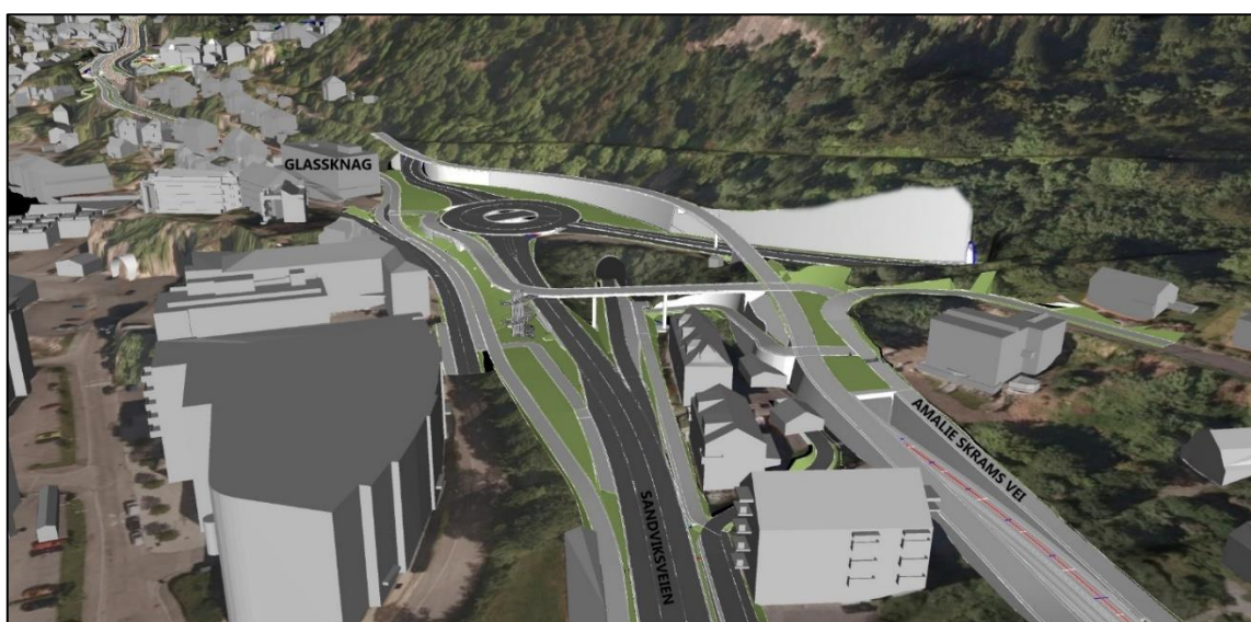
Figur 4-61: Modellutsnitt fra rundkjøring ved Glass Knag og ny gangbro over Sandviksveien, sett fra sør.
