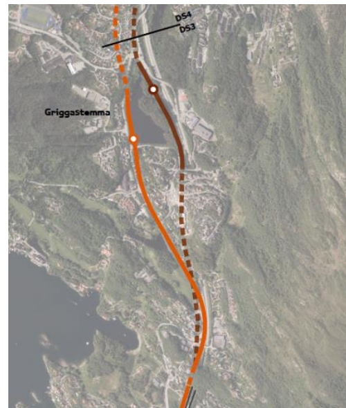
Figur 4-95: Trase fra KU2013 (brun) og anbefalt trase (oransje) mellom Eidsvåg og Tertneskrysset.
