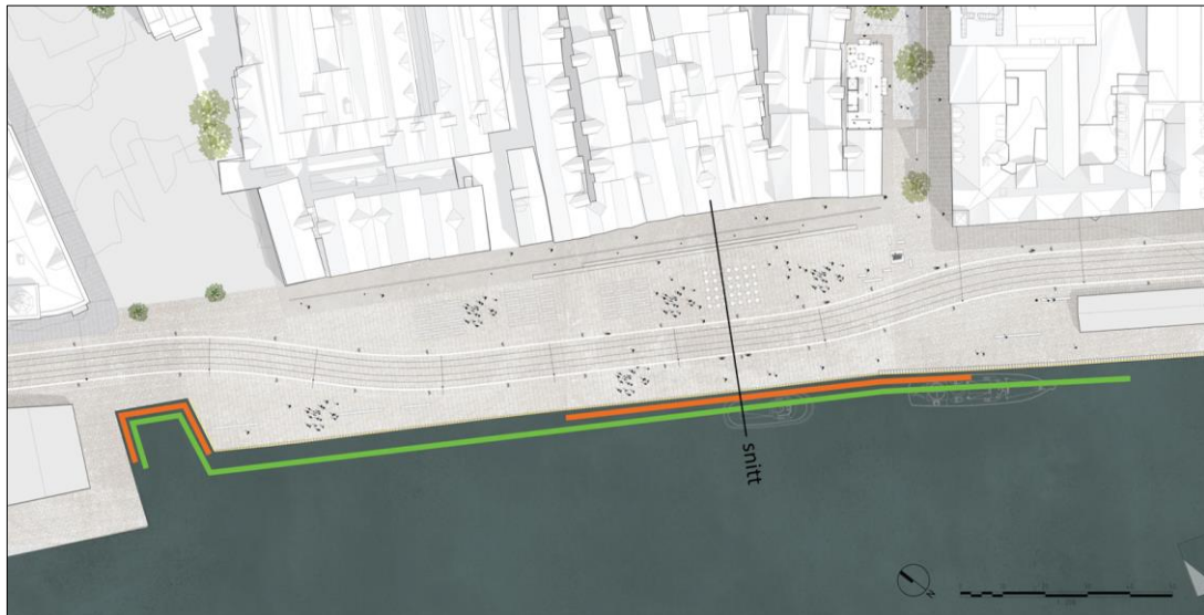
Figur 4-27: Hvilke deler av kaikanten som må heves for å få sidefall 1:70 (grønn) sammenliknet med hvilken del av kaikanten som må heves for å få sidefall på maksimum 1:50 (oransje). (Ill. Mot Vågen).
