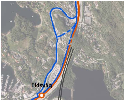
Vurderte løsninger for sykkel mellom Eidsvåg og Tertneskrysset. – vurderte løsninger for sykkel blå, anbefalt løsning bane oransje
