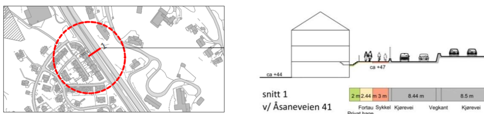
Figur 14: Snitt for mulig løsning langs E39 i bakken opp mot NHH. Inngrep i midtdeler og boligeiendommer kan gi 5,5 meter til sykkelvei med fortau.
