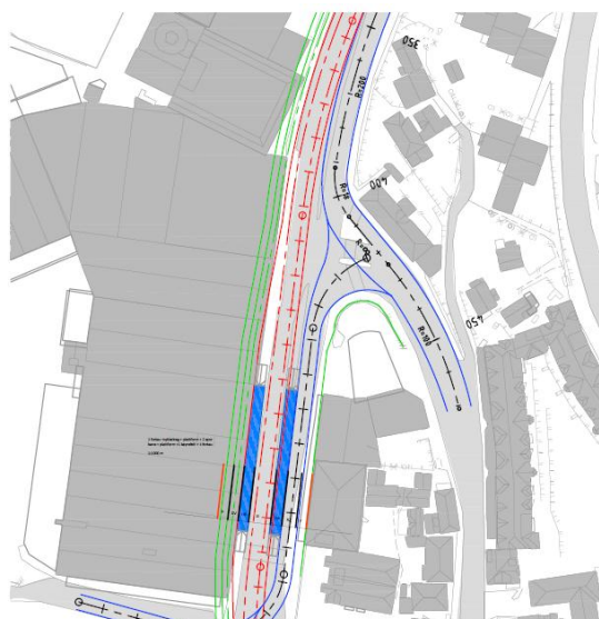
Figur 4: Geometritegning viser konflikt med eksisterende bebyggelse med separat sykkelvei langs Sjøgaten/ Sandviksveien og holdeplass forskjøvet nord for Sandvikstorget. Figur 5: Snitt ved forskjøvet holdeplass. Sandviksbodene 58 til venstre, Sandviksveien 44d til høyre.
