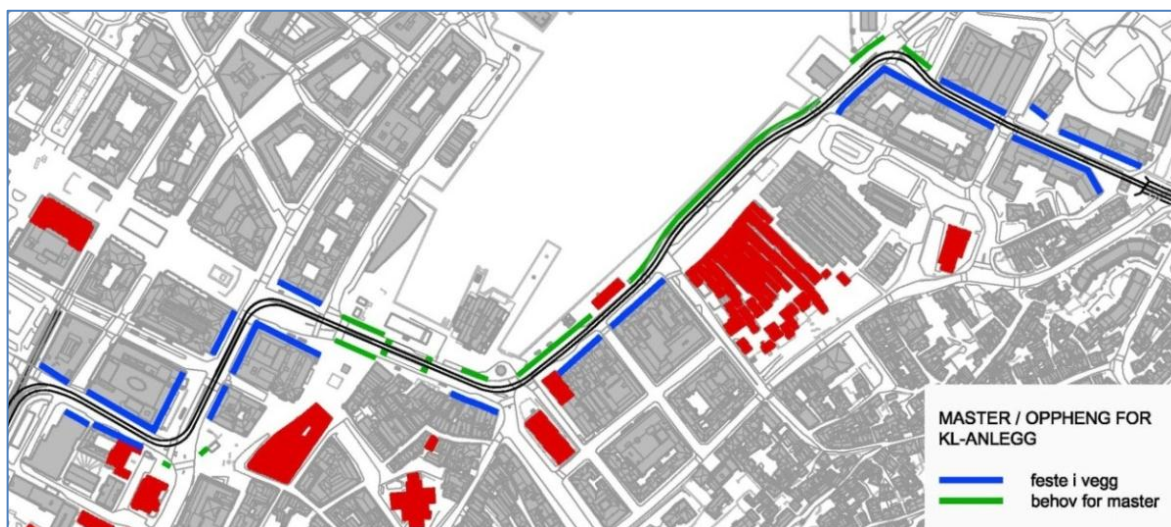
Figur 7: Mulig plassering av master og oppheng for kontaktledningsnett
